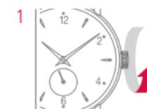
Krone vorsichtig mehrere Male im Uhrzeigersinn drehen, bis der Widerstand spürbar wird.
