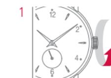
Ruotare la corona con cautela più volte, fino a che non si avverte resistenza.
