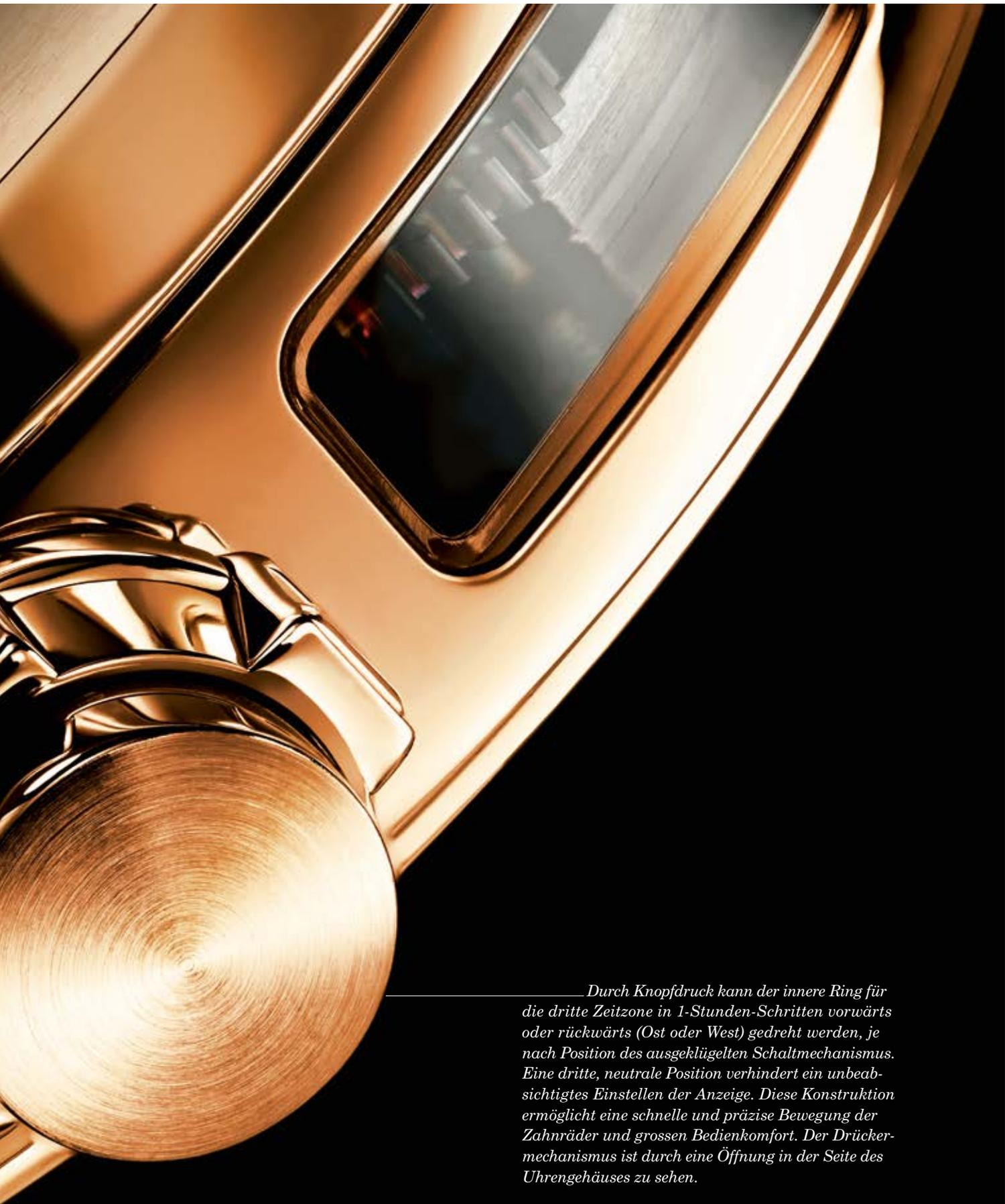
*Durch Knopfdruck kann der innere Ring für die dritte Zeitzone in 1-Stunden-Schritten vorwärts oder rückwärts (Ost oder West) gedreht werden, je nach Position des ausgeklügelten Schaltmechanismus. Eine dritte, neutrale Position verhindert ein unbeabsichtigtes Einstellen der Anzeige. Diese Konstruktion ermöglicht eine schnelle und präzise Bewegung der Zahnräder und grossen Bedienkomfort. Der Drückermechanismus ist durch eine Öffnung in der Seite des Uhregehäuses zu sehen.*
