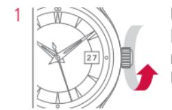
Um dem Werk genügend Energie zuzufügen, die Krone mindestens dreissig Mal im Uhrzeigersinn drehen.
