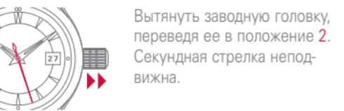
Вытянуть заводную головку, переведя ее в положение 2. Секундная стрелка неподвижна.
