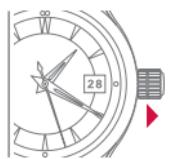
2 Das aktuelle Datum durch Drehen der Krone gegen den Uhrzeigersinn einstellen.
