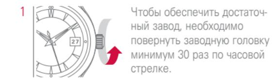
Чтобы обеспечить достаточный завод, необходимо повернуть заводную головку минимум 30 раз по часовой стрелке.
