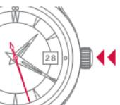
リューズを最初のポジションに押し戻します。秒針が再び動き始めます。
