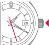
Poussez la couronne pour la replacer en position initiale. L'aiguille des secondes se remet en marche.
