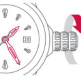
Вращая заводную головку против часовой стрелки, изменить дату. Затем установить текущее время «до полудня» или «после полудня».
