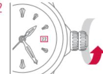
2 Réglez la date en tournant la couronne dans le sens des aiguilles d'une montre.
