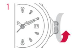
Um dem Werk genügend Energie zuzufügen, die Krone mindestens dreissig Mal im Uhrzeigersinn drehen.
