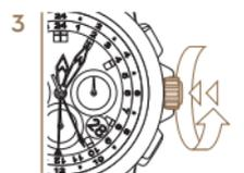
*Appuyez la couronne contre le boîtier et tournez-la simultanément dans le sens des aiguilles d'une montre jusqu'à ce qu'elle soit fermement vissée.*
