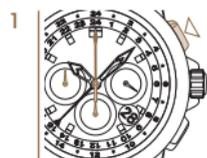
1 Inicie el tiempo de medición utilizando el pulsador P1. El contador de segundos está en movimiento.
