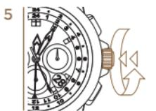
5 *Appuyez la couronne contre le boîtier et tournez-la simultanément dans le sens des aiguilles d'une montre jusqu'à ce qu'elle soit fermement vissée.*
