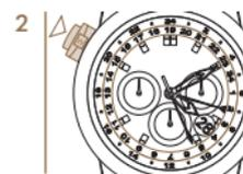
2 *Нажать на многофункциональную кнопку столько раз, сколько выбрано часовых поясов (в данном случае пять) и сохранить результат.*
