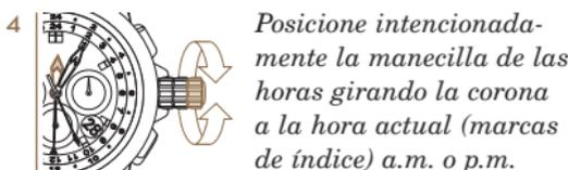
4 Posicione intencionadamente la manecilla de las horas girando la corona a la hora actual (marcas de índice) a.m. o p.m.
