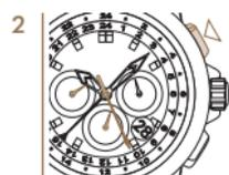
2 Para detener el tiempo de medición, vuelva a presionar el pulsador P1 y lea el tiempo transcurrido.
