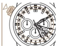
在本例子中, 红色 24 小时指针指着内圈的旋转式刻度显示纽约的时间, 以及指着固定外缘 24 小时刻度显示原居地伦敦的时间。
