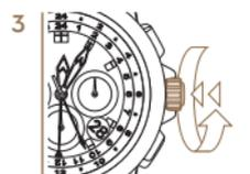
3 *Krone gegen das Gehäuse drücken und gleichzeitig im Uhrzeigersinn drehen, bis sie fest auf dem Gewinde sitzt.*
