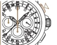
プッシュボタン P1 を押して時間計測を開始します。クロノグラフ秒針が動き始めます。
