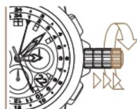
2 赤い24時間針をダイヤル外側の固定式24時間目盛の現在時に合わせます。そして、分針をダイヤルの目盛で現在時刻(分)に合わせます。2つとも合わせたら、リューズをポジション2の位置に押し戻します。
