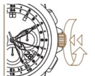
ダイヤル内側の回転式目盛で第3タイムゾーンを設定するには、モノプッシュボタンを使用します(例えば、ホームタイムのロンドンと5時間時差があるニューヨークの場合)。
