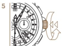
5 *Krone gegen das Gehäuse drücken und gleichzeitig im Uhrzeigersinn drehen, bis sie fest auf dem Gewinde sitzt.*
