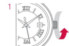
Чтобы обеспечить достаточный завод, необходимо повернуть заводную головку минимум 30 раз по часовой стрелке.
