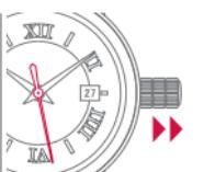
Вытянуть заводную головку, переведя ее в положение 2. Секундная стрелка неподвижна.
