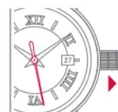
Krone bis zum Anschlag in Position 2 ziehen. Der Sekundenzeiger bleibt stehen.
