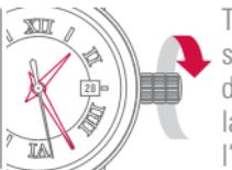
Tournez la couronne dans le sens inverse des aiguilles d'une montre jusqu'à ce que la date change; réglez l'heure sur a.m. ou p.m.
