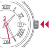
リューズを最初のポジションに押し戻します。秒針が再び動き始めます。
