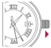
2 Das aktuelle Datum durch Drehen der Krone im Uhrzeigersinn einstellen.
