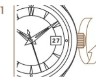
*Um dem Werk genügend Energie zuzufügen, die Krone mindestens dreissig Mal im Uhrzeigersinn drehen.*
