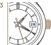
Poussez la couronne pour la replacer en position initiale. L'aiguille des secondes se remet en marche.
