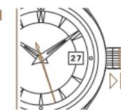
Вытянуть заводную головку, переведя ее в положение 2. Секундная стрелка неподвижна.
