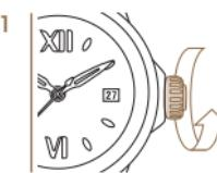
Чтобы обеспечить достаточный завод, необходимо повернуть заводную головку минимум 30 раз по часовой стрелке.
