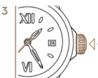
リューズを最初のポジションに押し戻します。秒針が再び動き始めます。
