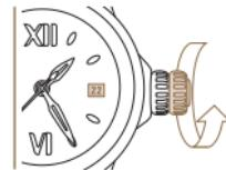
*Réglez la date en tournant la couronne dans le sens des aiguilles d'une montre.*
