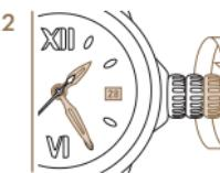
Вращая заводную головку против часовой стрелки, изменить дату. Затем установить текущее время «до полудня» или «после полудня».
