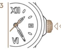
*Poussez la couronne pour la replacer en position initiale. L'aiguille des secondes se remet en marche.*
