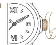
Per dare al movimento una potenza sufficiente, ruotare la corona almeno 30 volte in senso orario.
