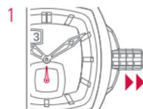
1 Krone bis zum Anschlag in Position 3 ziehen. Der Sekundenzeiger bleibt stehen.
