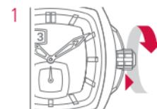
1 La couronne doit être libérée par une rotation dans le sens inverse des aiguilles d'une montre et sauter visiblement en position 1.
