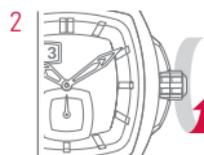
2 Um dem Werk genügend Energie zuzufügen, die Krone mindestens dreissig Mal im Uhrzeigersinn drehen.
