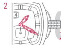
Girar la corona en el sentido de las agujas del reloj hasta cambiar la fecha. Luego ajuste la hora actual a AM o PM.
