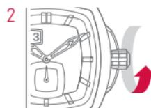
2 Per dare al movimento una potenza sufficiente, ruotare la corona almeno 30 volte in senso orario.
