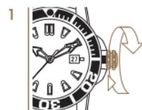
Заводная головка высвободится путем вращения против часовой стрелки, и будет видно, как она перескочит в положение 1.
