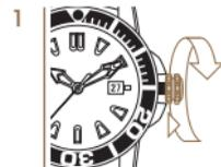
Die Krone wird durch Drehen gegen den Uhrzeigersinn entsichert und springt fühlbar auf Position 1.
