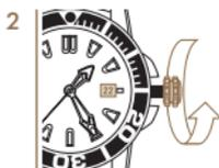
2 *Réglez la date en tournant la couronne dans le sens des aiguilles d'une montre.*
