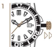
Вытянуть заводную головку, переведя ее в положение 3. Секундная стрелка неподвижна.
