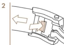
Para alargar el brazalete, mantenga pulsada la tecla de bloqueo y extraiga con cuidado el brazalete a la posición deseada.
