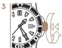
3 *Appuyez la couronne contre le boîtier et tournez-la simultanément dans le sens des aiguilles d'une montre jusqu'à ce qu'elle soit fermement vissée.*
