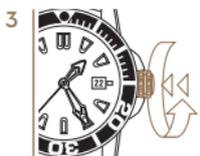
3 *Krone gegen das Gehäuse drücken und gleichzeitig im Uhrzeigersinn drehen, bis sie fest auf dem Gewinde sitzt.*
