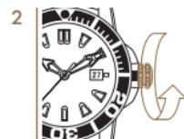
Per dare al movimento una potenza sufficiente, ruotare la corona almeno 30 volte in senso orario.
