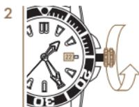
2 *Das aktuelle Datum durch Drehen der Krone im Uhrzeigersinn einstellen.*
