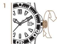
La couronne doit être libérée par une rotation dans le sens inverse des aiguilles d'une montre et sauter visiblement en position 1.
