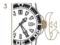
3 Прижать заводную головку к корпусу и одновременно повернуть ее по часовой стрелке настолько, чтобы она плотно завинтилась.
