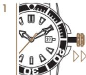
Krone bis zum Anschlag in Position 3 ziehen. Der Sekundenzeiger bleibt stehen.
