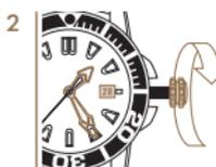
Tournez la couronne dans le sens inverse des aiguilles d'une montre jusqu'à ce que la date change; réglez l'heure sur a.m. ou p.m.
