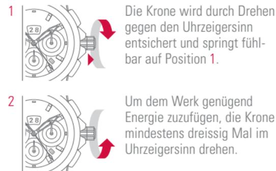
1 Die Krone wird durch Drehen gegen den Uhrzeigersinn entsichert und springt fühlbar auf Position 1.
