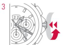
3 Appuyez la couronne contre le boîtier et tournez-la simultanément dans le sens des aiguilles d'une montre jusqu'à ce qu'elle soit fermement vissée.
