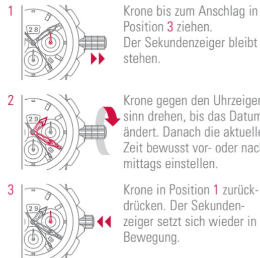
1 Krone bis zum Anschlag in Position 3 ziehen. Der Sekundenzeiger bleibt stehen.
