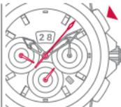
Para detener el tiempo de medición, vuelva a presionar el pulsador **P1** y lea el tiempo transcurrido.
