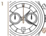
*Mentre la misurazione del tempo è in corso, premere il pulsante P2 per ripristinare tutti i contatori a zero. La successiva misurazione del tempo parte con il via. Per riportare tutti i contatori a zero, premere il pulsante P2 con la funzione cronografo arrestata.*
