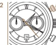
*Para detener el tiempo de medición, vuelva a presionar el pulsador P1. El contador de segundos se detiene inmediatamente.*
