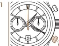
1 時間計測が進行している時に、プッシュボタンP2を押します。すべての積算計が0位置にリセットされ、自動的に次の時間計測がスタートします。その後すべての積算計を0にリセットするには、計測を一度ストップさせてプッシュボタンP2を押してください。
