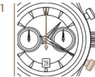
*Pendant que le comptage du temps est en cours, appuyez sur le poussoir P2 pour remettre l'ensemble des compteurs à zéro. Le comptage du temps suivant commence automatiquement. Afin de remettre l'ensemble des compteurs à zéro, appuyez sur le poussoir P2 avec la fonction chronographe arrêtée.*
