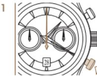
Bei laufender Zeitmessung den Drücker P2 drücken, um alle Zähler in die Nullstellung zu bringen. Beim Loslassen startet die nächste Zeitmessung. Um danach alle Zähler wieder in die Nullstellung zu bringen, den Drücker P2 bei gestoppter Chronographenfunktion betätigen.
