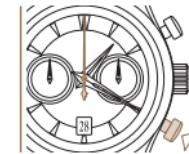
*Mientras esté la medición del tiempo en marcha, presione el pulsador P2 para reiniciar todos los contadores a cero. La siguiente medición de tiempo se inicia con comenzar. Para volver a poner todos los contadores a cero después de esto, presione el pulsador P2 con la función de cronógrafo detenida.*
