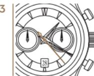
*Lea la velocidad media mediante la extensión óptica del contador de segundos.*
