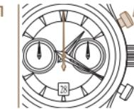
*Comience la función de taquímetro utilizando el pulsador P1. El contador de segundos está en movimiento.*
