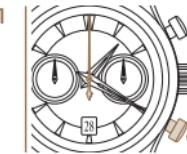
Пока фиксируется время, нажмите на кнопку P2 для обнуления всех счетчиков. При пуске начнется новое измерение времени. Для обнуления всех счетчиков после этого нажмите на кнопку P2 при остановленной работе хронографа.
