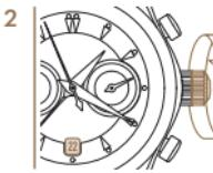
*Das aktuelle Datum durch Drehen der Krone gegen den Uhrzeigersinn einzustellen.*
