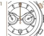
*Inicie el tiempo de medición utilizando el pulsador P1. El contador de segundos está en movimiento.*
