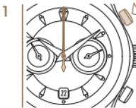
Начать отсчет времени кнопкой P1. Счетчик секунд находится в движении.
