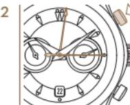
*Para detener el tiempo de medición, vuelva a presionar el pulsador P1 y lea el tiempo transcurrido.*
