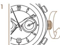
Чтобы обеспечить достаточный завод, необходимо повернуть заводную головку минимум 30 раз по часовой стрелке.
