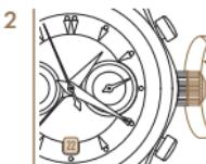
Réglez la date en tournant la couronne dans le sens inverse des aiguilles d'une montre.
