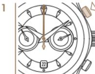
1 プッシュボタン P1 を押して時間計測を開始します。クロノグラフ秒針が動き始めます。
