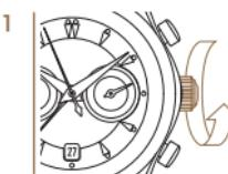
*Um dem Werk genügend Energie zuzufügen, die Krone mindestens dreissig Mal im Uhrzeigersinn drehen.*
