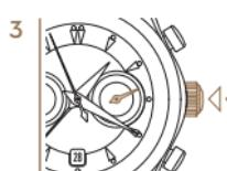
リューズを最初のポジションに押し戻します。秒針が再び動き始めます。
