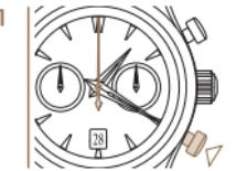
1 Пока фиксируется время, нажмите на кнопку P2 для обнуления всех счетчиков. При пуске начнется новое измерение времени. Для обнуления всех счетчиков после этого нажмите на кнопку P2 при остановленной работе хронографа.
