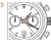
3 Lea la velocidad media mediante la extensión óptica del contador de segundos.
