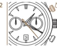
3 時間の計測を停止するには、再びプッシュボタンP1を押します。クロノグラフ秒針が瞬時に止まります。
