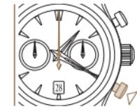
1 Mientras esté la medición del tiempo en marcha, presione el pulsador P2 para reiniciar todos los contadores a cero. La siguiente medición de tiempo se inicia con comenzar. Para volver a poner todos los contadores a cero después de esto, presione el pulsador P2 con la función de cronógrafo detenida.
