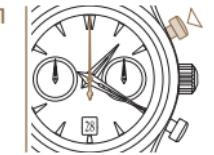
1 Включить тахиметр нажатием на кнопку P1. Счетчик секунд находится в движении.
