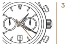
وبينما يكون قياس الوقت قيد التنفيذ، اضغط الصاغطة P2 لإعادة ضبط كل العدادات على صفر. تبدأ عملية قياس الوقت التالية بمجرد بدء التشغيل. ولإعادة ضبط كل العدادات على صرف بعد ذلك، اضغط الصاغطة P2 مع إيقاف تشغيل وظيفة الساعة الرياضية في نفس الوقت.
