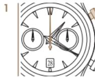
*Démarrez la fonction tachymètre en utilisant le poussoir P1. Le compteur de secondes est en marche.*
