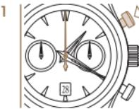
1 Comience la función de taquímetro utilizando el pulsador P1. El contador de segundos está en movimiento.
