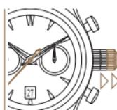
Вытянуть заводную головку, переведя ее в положение 2. Секундная стрелка неподвижна.
