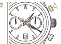
2 Для прекращения измерения времени нажать опять на кнопку P1. Счетчик секунд останавливается мгновенно.
