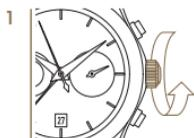
1 Чтобы обеспечить достаточный завод, необходимо повернуть заводную головку минимум 30 раз по часовой стрелке.
