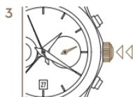
3 Poussez la couronne pour la replacer en position initiale. L'aiguille des secondes se remet en marche.
