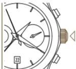
3 リュウズを最初のポジションに押し戻します。
