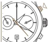
*Для прекращения измерения времени нажать опять на кнопку P1. Счетчик секунд останавливается мгновенно.*
