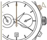
1 *Comience la función de taquímetro utilizando el pulsador P1. El contador de segundos está en movimiento.*
