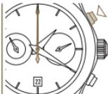
1 プッシュボタン P1 を押して時間計測を開始します。クロノグラフ秒針が動き始めます。
