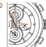
Mueva la corona en el sentido contrario a las agujas del reloj hasta que cambie la fecha. Después ajuste las manecillas, p. ej. a las 3:00 a.m.
