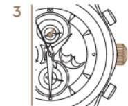
Poussez la couronne pour la replacer en position initiale. La petite aiguille des secondes se remet en marche.
