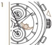
*Pulse el corrector A repetidamente hasta que la posición "luna llena" se muestre en la fase lunar.*
