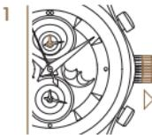
Krone bis zum Anschlag in Position 1 ziehen. Der kleine Sekundenzeiger bleibt stehen.
