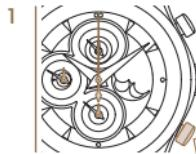
Mentre la misurazione del tempo è in corso, premere il pulsante P2 per ripristinare tutti i contatori a zero. La successiva misurazione del tempo parte con il via. Per riportare tutti i contatori a zero, premere il pulsante P2 con la funzione cronografo arrestata.
