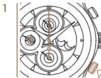
在計時進行期間，按 P2 按鈕令所有計時盤歸零，並自動即時展開下一項計時程式如要令所有計時盤歸零，只要 P2 按鈕，停止計時功能。
