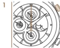
1 Démarrez la fonction tachymètre en utilisant le poussoir P1. Le compteur de secondes est en marche.
