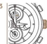
リューズを最初のポジションに押し戻します。スマートセコンドが再び動き始めます。
