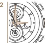
Вращать заводную головку против часовой стрелки до тех пор, пока не изменится дата. Затем установить стрелки, например, на 03:00 (утра).
