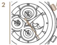
2 時間の計測を停止するには、再びプッシュボタンP1を押します。クロノグラフ秒針が瞬時に止まります。
