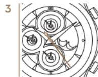
3 Lisez la vitesse moyenne grâce à l'extension optique du compteur de secondes.
