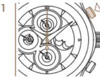
1 Включить тахиметр нажатием на кнопку P1. Счетчик секунд находится в движении.
