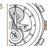
*Poussez la couronne pour la replacer en position initiale. La petite aiguille des secondes se remet en marche.*
