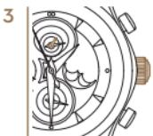
リューズを最初のポジションに押し戻します。スモールセコンドが再び動き始めます。
