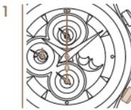
1 *Bei laufender Zeitmessung den Drücker P2 drücken, um alle Zähler in die Nullstellung zu bringen. Beim Loslassen startet die nächste Zeitmessung. Um danach alle Zähler wieder in die Nullstellung zu bringen, den Drücker P2 bei gestoppter Chronographenfunktion betätigen.*
