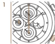
1 Pendant que le comptage du temps est en cours, appuyez sur le poussoir P2 pour remettre l'ensemble des compteurs à zéro. Le comptage du temps suivant commence automatiquement. Afin de remettre l'ensemble des compteurs à zéro, appuyez sur le poussoir P2 avec la fonction chronographe arrêtée.
