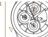
*Ajuste la fecha: Pulse el corrector C repetidamente hasta que el indicador de fecha muestre 1.*
