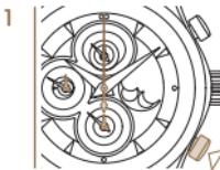
1 Пока фиксируется время, нажмите на кнопку P2 для обнуления всех счетчиков. При пуске начнется новое измерение времени. Для обнуления всех счетчиков после этого нажмите на кнопку P2 при остановленной работе хронографа.
