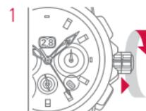
Die Krone wird durch Drehen gegen den Uhrzeigersinn entsichert und springt fühlbar auf Position 1.
