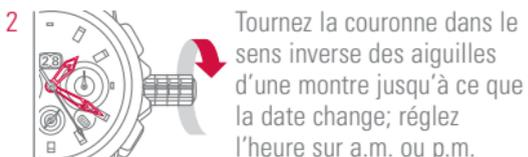
Tournez la couronne dans le sens inverse des aiguilles d'une montre jusqu'à ce que la date change; réglez l'heure sur a.m. ou p.m.
