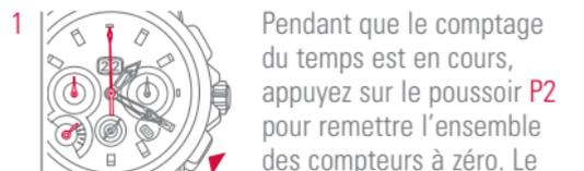
Pendant que le comptage du temps est en cours, appuyez sur le poussoir P2 pour remettre l'ensemble des compteurs à zéro. Le comptage du temps suivant commence automatiquement. Afin de remettre l'ensemble des compteurs à zéro, appuyez sur le poussoir P2 avec la fonction chronographe arrêtée.
