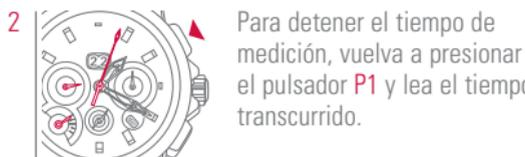
Para detener el tiempo de medición, vuelva a presionar el pulsador P1 y lea el tiempo transcurrido.
