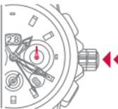
リューズを元のポジション1に押し戻します。秒針が再び動き始めます。
