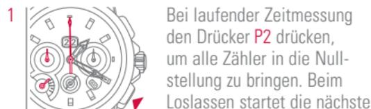
1 Bei laufender Zeitmessung den Drücker P2 drücken, um alle Zähler in die Nullstellung zu bringen. Beim Loslassen startet die nächste Zeitmessung. Um danach alle Zähler wieder in die Nullstellung zu bringen, den Drücker P2 bei gestoppter Chronographenfunktion betätigen.
