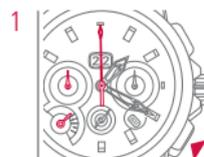
Mientras esté la medición del tiempo en marcha, presione el pulsador P2 para reiniciar todos los contadores a cero. La siguiente medición de tiempo se inicia con comenzar. Para volver a poner todos los contadores a cero después de esto, presione el pulsador P2 con la función de cronógrafo detenida.
