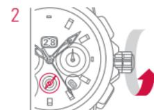
Вращать заводную головку по часовой стрелке до тех пор, пока стрелка индикации запаса хода не выйдет из красной зоны.
