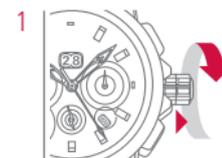
Заводная головка высвободится путем вращения против часовой стрелки, и будет видно, как она перескочит в положение 1.
