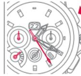
プッシュボタン P1 を押して時間計測を開始します。クロノグラフ秒針が動き始めます。
