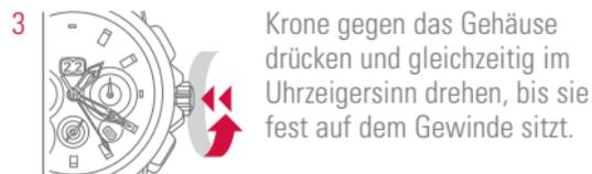
3 Krone gegen das Gehäuse drücken und gleichzeitig im Uhrzeigersinn drehen, bis sie fest auf dem Gewinde sitzt.
