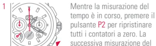
Mentre la misurazione del tempo è in corso, premere il pulsante P2 per ripristinare tutti i contatori a zero. La successiva misurazione del tempo parte con il via. Per riportare tutti i contatori a zero, premere il pulsante P2 con la funzione cronografo arrestata.
