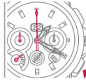
時間計測が進行している時に、プッシュボタン P2 を押します。すべての積算計が0位置にリセットされ、自動的に次の時間計測がスタートします。その後すべての積算計を0にリセットするには、計測を一度ストップさせてプッシュボタン P2 を押してください。
