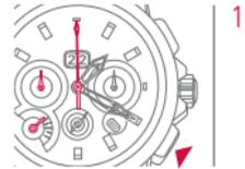
1 وبينما يكون قياس الوقت قيد التنفيذ، اضغط الضاغطة P2 لإعادة ضبط كل العدادات على صفر. تبدأ عملية قياس الوقت التالية بمجرد بدء التشغيل. وإعادة ضبط كل العدادات على صفر بعد ذلك، اضغط الضاغطة P2 مع إيقاف تشغيل وظيفة الساعة الرياضية في نفس الوقت.
