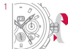
1 La couronne doit être libérée par une rotation dans le sens inverse des aiguilles d'une montre et sauter visiblement en position 1.
