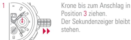
1 Krone bis zum Anschlag in Position 3 ziehen. Der Sekundenzeiger bleibt stehen.
