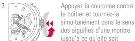
Appuyez la couronne contre le boîtier et tournez-la simultanément dans le sens des aiguilles d'une montre jusqu'à ce qu'elle soit fermement vissée.
