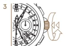
3 *Прижать заводную головку к корпусу и одновременно повернуть ее по часовой стрелке настолько, чтобы она плотно завинтилась.*
