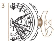
3 *Krone gegen das Gehäuse drücken und gleichzeitig im Uhrzeigersinn drehen, bis sie fest auf dem Gewinde sitzt.*
