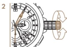
2 *Roten 24-Stunden-Zeiger auf die aktuelle Stunde der äusseren, fixen Skala und den Minutenzeiger auf die aktuelle Minute (Indexstriche) stellen. Danach die Krone in Position 2 zurückdrücken.*
