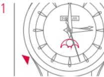
Appuyez de manière répétée sur le correcteur C jusqu'à ce que la position "pleine lune" apparaisse dans la phase de lune.
