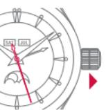
Вытянуть заводную головку, переведя ее в положение 1. Секундная стрелка неподвижна.
