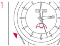
Pulse el corrector **C** repetidamente hasta que la posición "luna llena" se muestre en la fase lunar.
