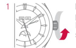
Per dare al movimento una potenza sufficiente, ruotare la corona almeno 30 volte in senso orario.
