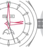
Mueva la corona en el sentido contrario a las agujas del reloj hasta que cambie la fecha. Después ajuste las manecillas, p. ej. a las 3:00 a.m.
