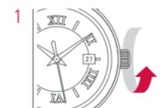
Чтобы обеспечить достаточный завод, необходимо повернуть заводную головку минимум 30 раз по часовой стрелке.
