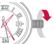
Вращая заводную головку против часовой стрелки, изменить дату. Затем установить текущее время «до полудня» или «после полудня».
