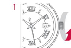
Per dare al movimento una potenza sufficiente, ruotare la corona almeno 30 volte in senso orario.
