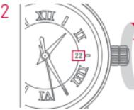
Réglez la date en tournant la couronne dans le sens inverse des aiguilles d'une montre.
