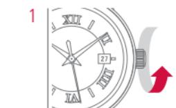
Um dem Werk genügend Energie zuzufügen, die Krone mindestens dreissig Mal im Uhrzeigersinn drehen.
