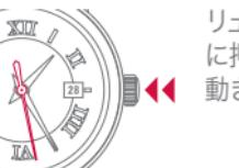
4 リューズを最初のポジションに押し戻します。秒針が再び動き始めます。
