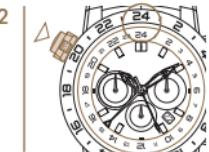
*Appuyez de manière répétée sur le monopoussoir jusqu'à ce que le 24 sur l'échelle rotative soit situé au-dessous du 24 sur l'échelle de la lunette.*
