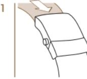
1 ストラップを短くするには、クラスプを閉じたまま注意してストラップ押し戻します。
