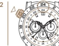
Monodrücker so oft betätigen, bis die Zahl 24 der drehbaren Skala unter der Zahl 24 der Lünetten-Skala steht.
