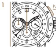
Inicie el tiempo de medida utilizando el pulsador P1. El contador de segundos está en movimiento.
