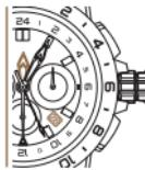
2 *Impostare la data attuale, usando la lancetta delle ore, mediante la rotazione della corona. La lancetta 24 ore rossa non si muove.*
