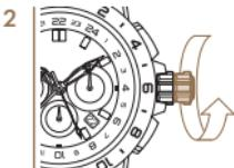
*Per dare al movimento una potenza sufficiente, ruotare la corona almeno 30 volte in senso orario.*
