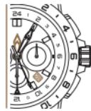
2 *Réglez la date en tournant la couronne pour actionner l'aiguille des heures. L'aiguille rouge de l'affichage 24 heures ne bouge pas.*
