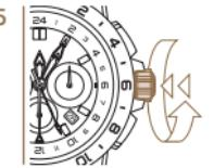
Appuyez la couronne contre le boîtier et tournez-la simultanément dans le sens des aiguilles d'une montre jusqu'à ce qu'elle soit fermement vissée.
