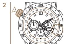
在本例子中，紅色 24 小時指針指著內圈的旋轉式刻度顯示紐約的時間，以及指著錶圈的 24 小時刻度顯示原居地倫敦的時間。
