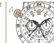
*Premere il monopulsante ripetutamente, fino a che il 24 sulla scala ruotabile non si trova sotto al 24 sulla scala sul bordo.*
