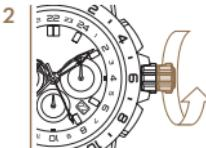
Чтобы обеспечить достаточный завод, необходимо повернуть заводную головку минимум 30 раз по часовой стрелке.
