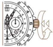
3 *Appuyez la couronne contre le boîtier et tournez-la simultanément dans le sens des aiguilles d'une montre jusqu'à ce qu'elle soit fermement vissée.*
