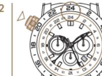
*Pulse el monopulsador repetidamente hasta que el 24 en la escala giratoria quede por debajo del 24 en la escala fija.*
