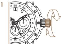
*La couronne doit être libérée par une rotation dans le sens inverse des aiguilles d'une montre et sauter visiblement en position 1.*
