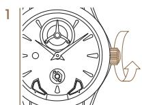
Um dem Werk genügend Energie zuzufügen, die Krone mindestens 30 Mal im Uhrzeigersinn drehen.
