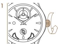
*Pour donner suffisamment d'énergie au mouvement, tournez la couronne au moins 30 fois dans le sens des aiguilles d'une montre.*
