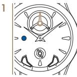
*Tirer la couronne jusqu'au point de butée (position 1). L'aiguille des secondes de la cage du tourbillon s'arrête.*
