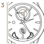
*Appuyer sur la couronne pour lui faire regagner sa position de départ. L'aiguille des secondes de la cage du tourbillon se remet en mouvement.*
