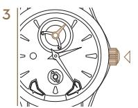
3 Appuyer sur la couronne pour lui faire regagner sa position de départ. L'aiguille des secondes de la cage du tourbillon se remet en mouvement.
