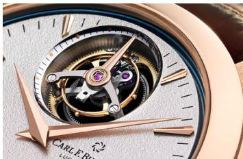
陀飞轮是标志性的制表工艺之一，装置可抵消机械腕表的时间误差。由于腕表在腕上位置不尽相同，导致机芯走时均会受到地心重力影响。为减少对走时的影响，制表师研發出一个自转框架，并可相互抵消重力。如此一来，腕表摆放位置不再影响走时精准。腕表的三问陀飞轮结构由外缘框架支撑，并由三个隐藏的球型轴承支撑。使陀飞轮看似悬浮在空中，更备有停秒功能。当佩戴者拉出表冠时，陀飞轮框架随即锁定，并可调校时间精准至秒钟。
