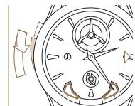
向下推动三问报时的滑动杆，然后松开。显示时间时无法拉出表冠。
