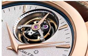
Autre grande prouesse horlogère: le tourbillon, lequel permet de compenser les variations inhérentes à une montre mécanique. En raison des diverses positions que prend la montre portée au poignet, la gravité terrestre a un impact sur les mouvements du balancier. Afin de compenser ces perturbations, une cage tournante hébergeant l'organe réglant ainsi que l'échappement a été mise au point. Ceci permet de compenser les écarts de marche dans les positions verticales.
