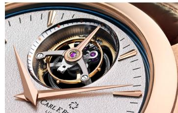
時計製造技術において、ミニツツリピーターと並ぶハイライトといえるトゥールビヨンは、機械式時計の動きで生じる誤差を補完する機構です。手首の動きによって、時計が様々な位置や向きになるため、ムーブメントは地球の重力の影響を少なからず受けます。この影響を最小限にするため、回転するキャリッジが開発されテンプが調整されたのです。この機構によって、テンプと重力による抵抗とが互いに働き合うことができ、機械が時計の位置とは関係なく独立して動くことができます。
