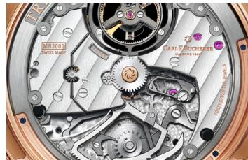
ローズゴールドの鍾を持つペリフェラルローターによってゼンマイにパワーを蓄えます。スリムな形状のローターは高効率の巻上げに加えて、ムーブメント全体を楽しめるという利点もあります。このペリフェラルローターはさらにフローティングトゥールビヨンへと繋がります。いずれもカール F. ブヘラによる革新的な技術でいくつかの特許を取得しています。緻密な仕上げを施されたCOSC認定クロノメーター、自社製キャリバーMR3000は65時間のパワーリザーブで、ペリフェラル技術の新しい時代を開きました。そして、このマネロ ミニツツリピーター シンフォニーの心臓部を形作っているのです。
