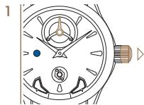
将表冠拉到位置 1 止挡处。秒针停在陀飞轮框架上。
