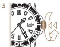
Прижать заводную головку к корпусу и одновременно повернуть ее по часовой стрелке настолько, чтобы она плотно завинтилась.
