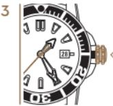
Вытянуть заводную головку, переведя ее в положение 3. Секундная стрелка неподвижна.
