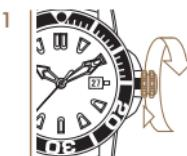
*Die Krone wird durch Drehen gegen den Uhrzeigersinn entsichert und springt fühlbar auf Position 1.*
