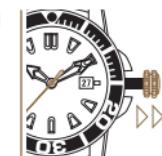
*Krone bis zum Anschlag in Position 3 ziehen. Der Sekundenzeiger bleibt stehen.*
