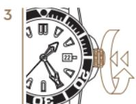
Krone gegen das Gehäuse drücken und gleichzeitig im Uhrzeigersinn drehen, bis sie fest auf dem Gewinde sitzt.
