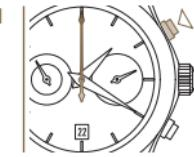
1 Comience la función de taquímetro utilizando el pulsador P1. El contador de segundos está en movimiento.
