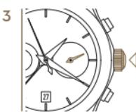
リューズを最初のポジションに押し戻します。秒針が再び動き始めます。
