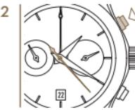
Для прекращения измерения времени нажать опять на кнопку P1. Счетчик секунд останавливается мгновенно.
