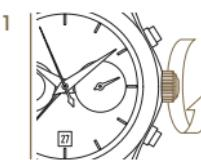
Чтобы обеспечить достаточный завод, необходимо повернуть заводную головку минимум 30 раз по часовой стрелке.
