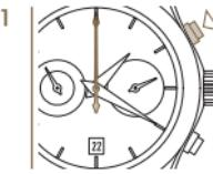
1 プッシュボタンP1を押して時間計測を開始します。クロノグラフ秒針が動き始めます。
