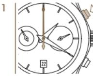
Начать отсчет времени кнопкой P1. Счетчик секунд находится в движении.
