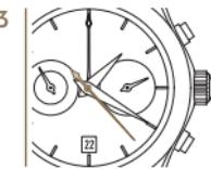
3 Lea la velocidad media mediante la extensión óptica del contador de segundos.
