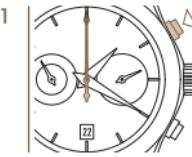
Включить тахиметр нажатием на кнопку P1. Счетчик секунд находится в движении.
