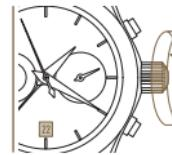
2 *Réglez la date en tournant la couronne dans le sens inverse des aiguilles d'une montre.*
