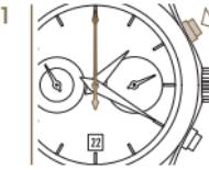
1 *Démarrez la fonction tachymètre en utilisant le poussoir P1. Le compteur de secondes est en marche.*
