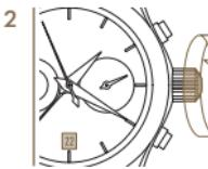
Das aktuelle Datum durch Drehen der Krone gegen den Uhrzeigersinn einstellen.
