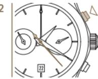
2 Para detener el tiempo de medición, vuelva a presionar el pulsador P1. El contador de segundos se detiene inmediatamente.
