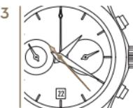
3 *Lisez la vitesse moyenne grâce à l'extension optique du compteur de secondes.*
