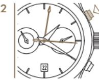
2 Para detener el tiempo de medición, vuelva a presionar el pulsador P1 y lea el tiempo transcurrido.
