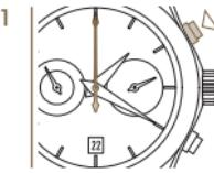
1 Inicie el tiempo de medición utilizando el pulsador P1. El contador de segundos está en movimiento.
