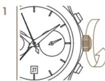
Per dare al movimento una potenza sufficiente, ruotare la corona almeno 30 volte in senso orario.
