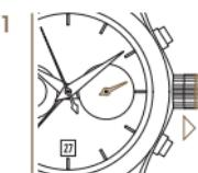
Krone bis zum Anschlag in Position 2 ziehen. Der Sekundenzeiger bleibt stehen.
