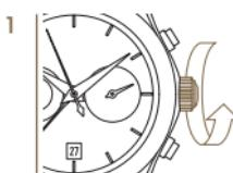
Um dem Werk genügend Energie zuzufügen, die Krone mindestens dreissig Mal im Uhrzeigersinn drehen.
