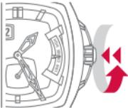
Krone gegen das Gehäuse drücken und gleichzeitig im Uhrzeigersinn drehen, bis sie fest auf dem Gewinde sitzt.
