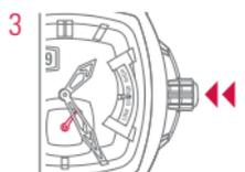
3 リューズを元のポジション1に押し戻します。秒針が再び動き始めます。
