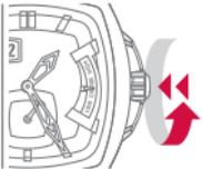
Прижать заводную головку к корпусу и одновременно повернуть ее по часовой стрелке настолько, чтобы она плотно завинтилась.
