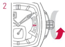
2 顺时针方向转动表冠，直至动力储存显示指针离开 LOW 区域。
