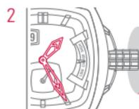
2 Tournez la couronne dans le sens des aiguilles d'une montre jusqu'à ce que la date change. Puis réglez l'heure sur a.m. ou p.m.
