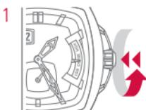
Appuyez la couronne contre le boîtier et tournez-la simultanément dans le sens des aiguilles d'une montre jusqu'à ce qu'elle soit fermement vissée.
