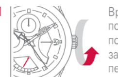
Вращать заводную головку по часовой стрелке до тех пор, пока стрелка индикации запаса хода полностью не перейдет к середине шкалы.
