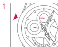
1 Тонким предметом нажать несколько раз на кнопку корректировки A до тех пор, пока стрелка не покажет нужный час.
