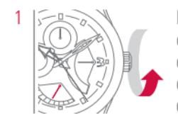
Ruotare la corona in senso orario fino a che la lancetta dell'indicatore dell'autonomia di carica non s'è spostata completamente verso il centro della scala.
