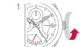
Tournez la couronne dans le sens des aiguilles d'une montre jusqu'à ce que l'aiguille de l'indicateur de réserve de marche ait parcouru toute la distance jusqu'au milieu de l'échelle.
