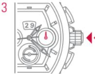
3 リューズを元のポジション1に押し戻します。秒針が再び動き始めます。
