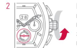
Вращать заводную головку по часовой стрелке до тех пор, пока стрелка индикации запаса хода не выйдет из красной зоны.
